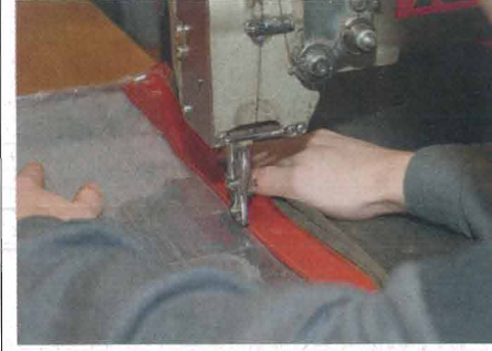
1. Eine präzise gesetzte Naht mit Polstergarn genügt völlig, damit das Fenster dauerhaft fest im Rahmen sitzt.
