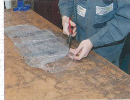
6. Die überschüssige Folie am Rand des Fensters wird sorgfältig mit einer Schere entfernt.
