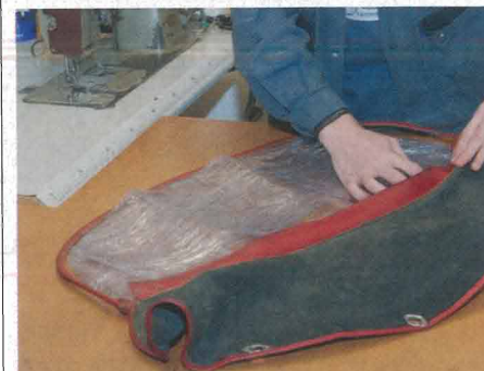
7. Das Einpassen des neuen Kunststofffensters erfordert Augenmaß, da es zentriert im Rahmen liegen muss.
