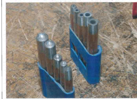
10. Für das Plattschlagen der Nieten braucht es spezielles Werkzeug. Die Größe des Nietstempels hängt von der Niete ab.
