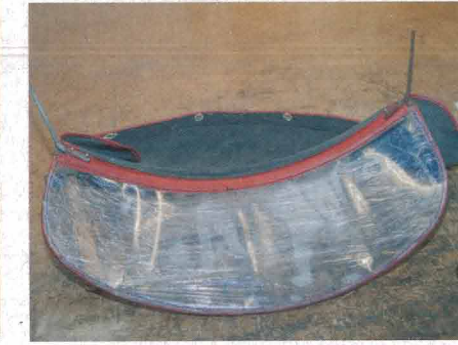
9. Der Spritzschutz ist wieder in seine ursprüngliche Form gebracht. Noch sind aber die vier Nieten nicht vernietet.
