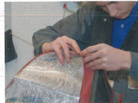
8. An den Ecken des Rahmens muss er aufpassen, da sich hier der Einschub für die Verstärkungsstange befindet.
