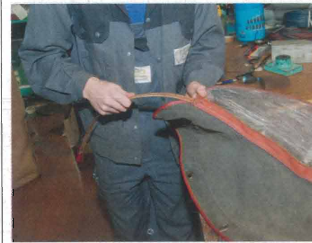
4. Die formgebende Verstärkungsstange wird durch den Einschub in den unteren Rahmen eingeschoben.
