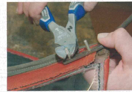
11. Der Nietstift darf nicht zu lang oder zu kurz sein. Augenmaß ist beim Kürzen erforderlich.
