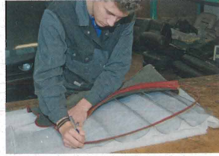
3. Vom Rahmen des Spritzschutzes muss er die Kontur des Kunststofffensters abnehmen.
