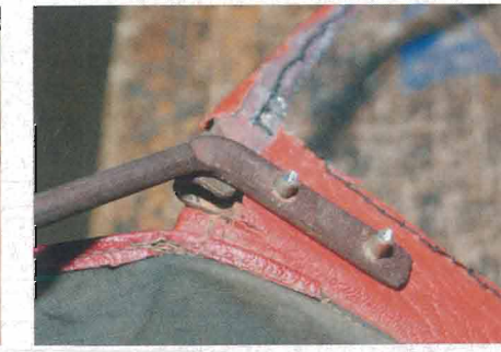
12. Rund auf vier Millimeter Höhe hat der Auszubildende die Nietstifte mit dem Seitenschneider gekürzt.
