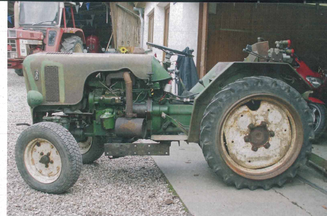
Der heute seltene Bungartz T8/34 Schmalspur-Kleintraktor wurde viel im Weinbau eingesetzt. Zum Schutz vor Schmutz wurde oft ein Spritzschutz montiert.
