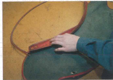
1. Dieser Spritzschutz wurde an einem Bungartz T8/34 nachgerüstet. Das Kunststoffglas wurde vom Besitzer entfernt.
