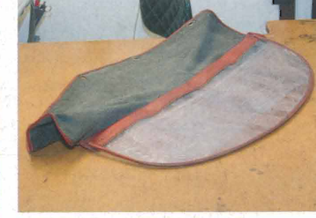
3. Ralf ist mit seiner Arbeit zufrieden. Das neue Kunststofffenster ist eingenäht. Es sitzt genau im Rahmen.
