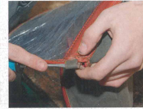
6. Mit einem Schraubendreher richtet Ralf die Verstärkungsstange und Klammern auf die Bohrungen der Nieten aus.
