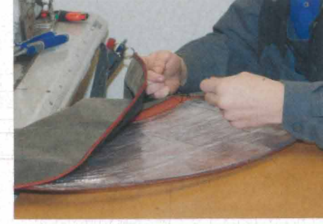
2. Den Anfang und das Ende der Naht muss Ralf miteinander verknoten, damit sie sich nicht mehr öffnen kann.
