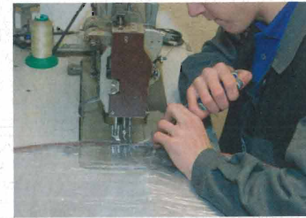
12. Jedes Mal, wenn eine Klammer beim Nähen stören würde, entfernt sie Ralf kurz vorher mit einer Spitzzange.
