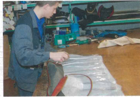
2. Ralf hat die passende Kunststoffolie aus dem Lager geholt und schneidet ein genügend großes Stück ab.
