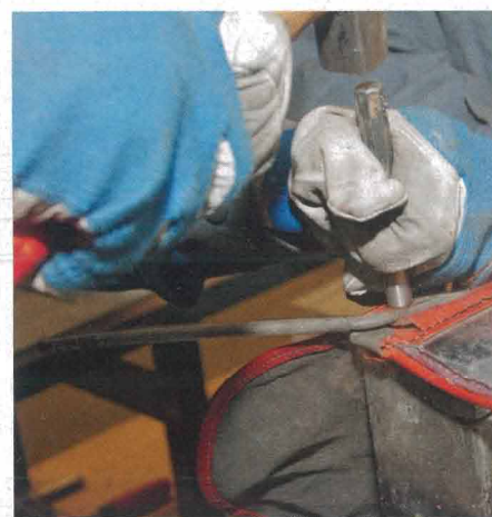
Zum Plattschlagen der Nietköpfe legt Heinz den jeweiligen Nietkopf auf einen speziellen Amboss auf.
