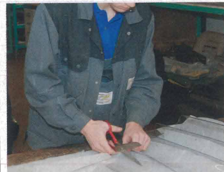
4. Mit einer scharfen Schere schneidet er aus der Kunststoffolie das neue Fenster für den Spritzschutz aus.
