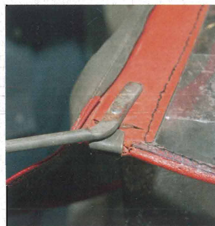
Eine professionelle Nietung erkennt man an einem linsenartigen runden Kopf, der die Nietbohrung völlig abdeckt.
