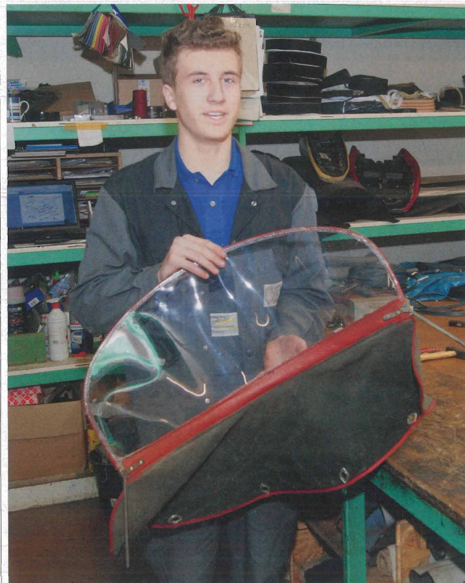
Ralf darf zufrieden sein. Der Spritzschutz ist wieder voll einsatzfähig und kann am Bungartz T8/34 Schmalspur-Kleintraktor des Kunden montiert werden.
