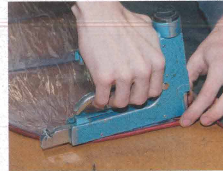
9. Damit sich das Kunststofffenster nicht mehr verschieben kann, wird es am Rahmen angetackert.
