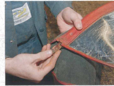
5. Auch die Klammern, die den Drahtbogen des oberen Rahmens halten, müssen in den Einschub gesteckt werden.
