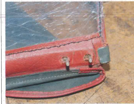
7. Die Nieten sind eingesteckt. Sie halten den Drahtrahmen, die Verstärkungsstange und die Klammern zusammen.
